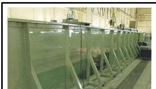
■造波長水路 (50m長水路) (鋼製両面一部強化ガラス張り、50m×1m×1.5m) 一方向から造波し、防波堤、護岸などの安定性や消波効果、越波防止効果などを把握するための施設です。
