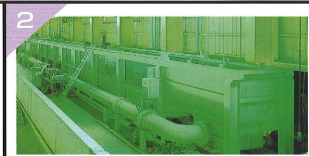
2 ■造波・廻流長水路 (41m長水路) (鋼製両面一部強化ガラス張り、41m×0.8m×1.25~0.95m) 一方向から波と潮流を同時に作用させ、防波堤、護岸、消波ブロックの波に対する安定性を把握します。ガラス張りの側面から模型の断面を観察できるようになっています。
