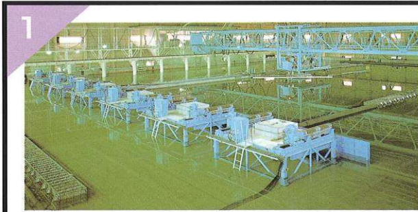
1 ■潮流・波浪実験水槽 (61.0m×48.5m×1.5m) 防波堤による波の遮へい効果や埋め立てや航路の掘削によって生じる海底地形の変化による潮流の影響を調べる潮流実験を行う施設です。
